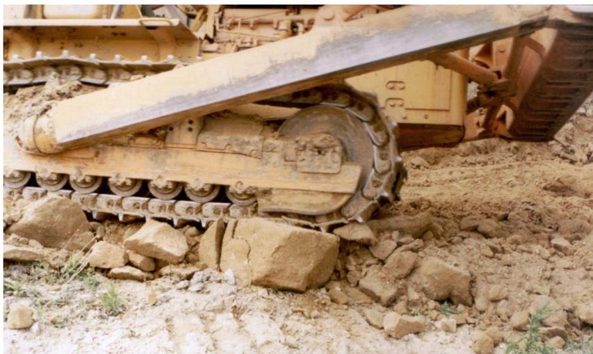
Foto 7. Troceando areniscas con la teja del ripper.
